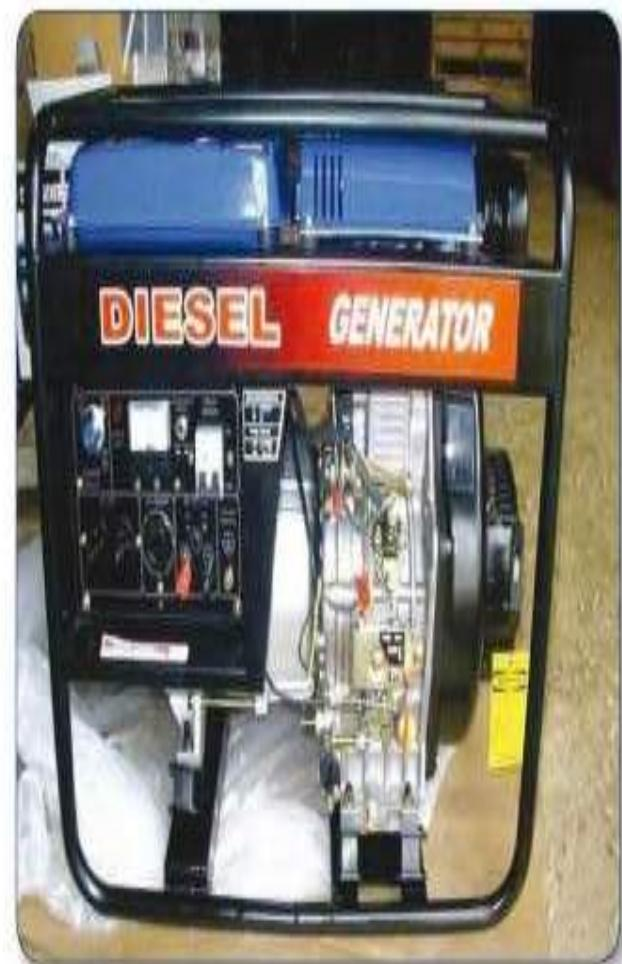
احتراق الوقود في ماكينة الاحتراق الداخلي ينتج طاقة ميكانيكية ثم تحول الطاقة الميكانيكية إلى طاقة كهربائية بواسطة المولد الكهربائي.
